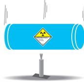
**Perforación:** caída desde 3 m sobre una barra (peso del bulto  $\geq$  250 kg)
